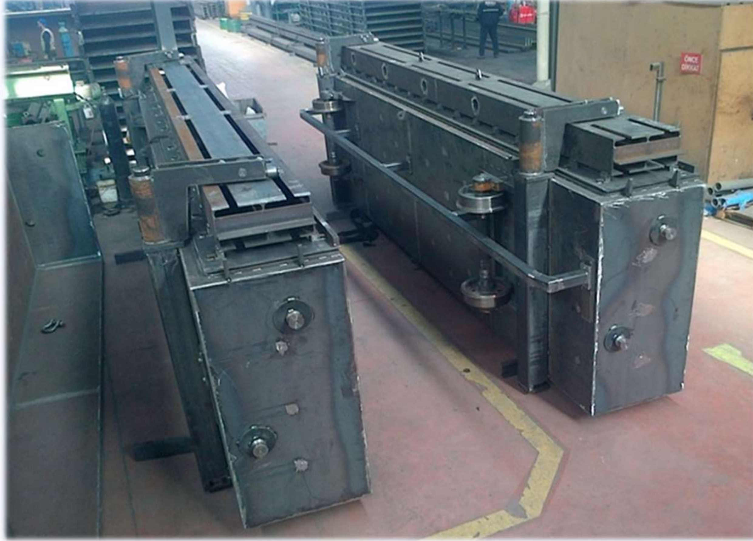
MOLD ASSEMBLY - EGE GAZBETON- AYDIN SÖKE
